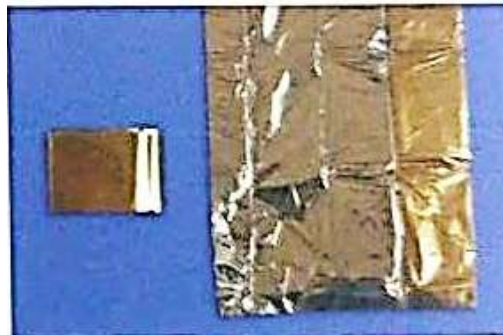
Poliesterska folija metalna (najmanja mjera 150 cm x 200 cm, najmanje debljine 12 \mu m) - 1 kom
